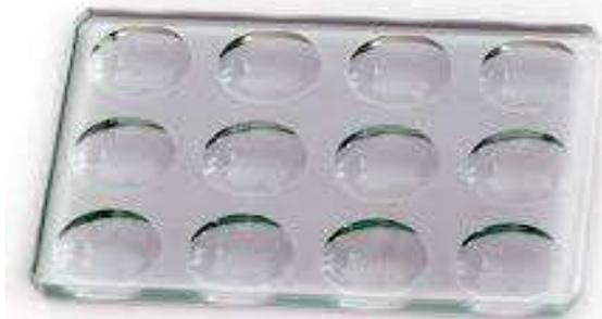
**Figura 23** – Porta-amostras tipo placa de Kline, em vidro, com volume de 300  $\mu\text{L}$ .
