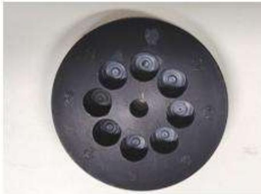
**Figura 22** – Porta-amostras em alumínio anodizado preto-fosco, com volume de 400  $\mu\text{L}$ .
