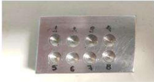
**Figura 21** – Porta-amostras em alumínio com oito furos, com volume de 80  $\mu\text{L}$ .
