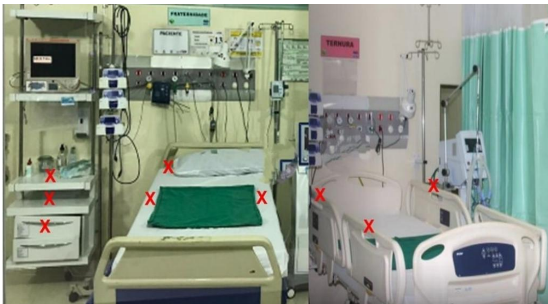
Figura 10: Locais de aquisição das amostras em superfícies assistenciais através da bioluminescência de Trifosfato de Adenosina (Luminômetro SystemSure Plus).
