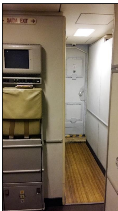
Figura 14 - Porta blindada da cabine de comando do Boeing 777, acima da porta posiciona-se a câmera externa
