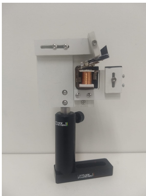
Figura 25 – Elemento atuador contendo o relé automotivo DNI0102 fixado a base de operação.
