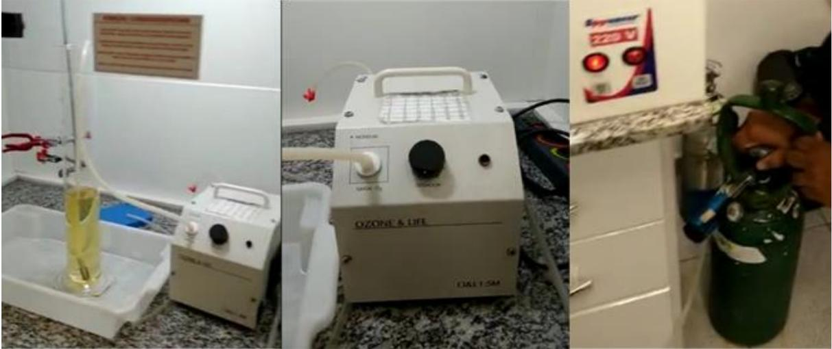
**Figura 3.** Imagem fotográfica do aparato adaptado para ozonização do óleo de girassol.
