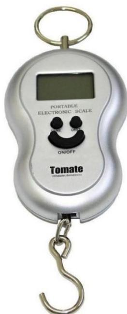
**Figura 15** Dinamômetro digital portátil
