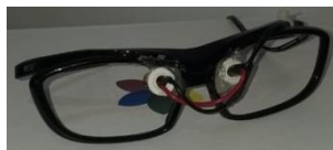
Figura 2: Dispositivo óptico adaptado para FBMC via TSO (Fonte: Autor).
