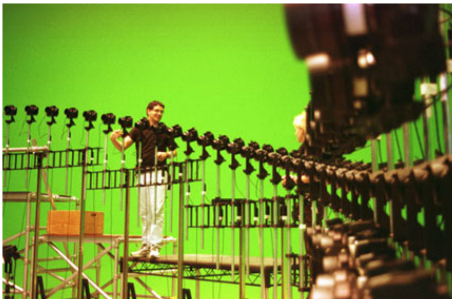
Fig. 23 - As câmeras usadas para filmar o Bullet-time.
