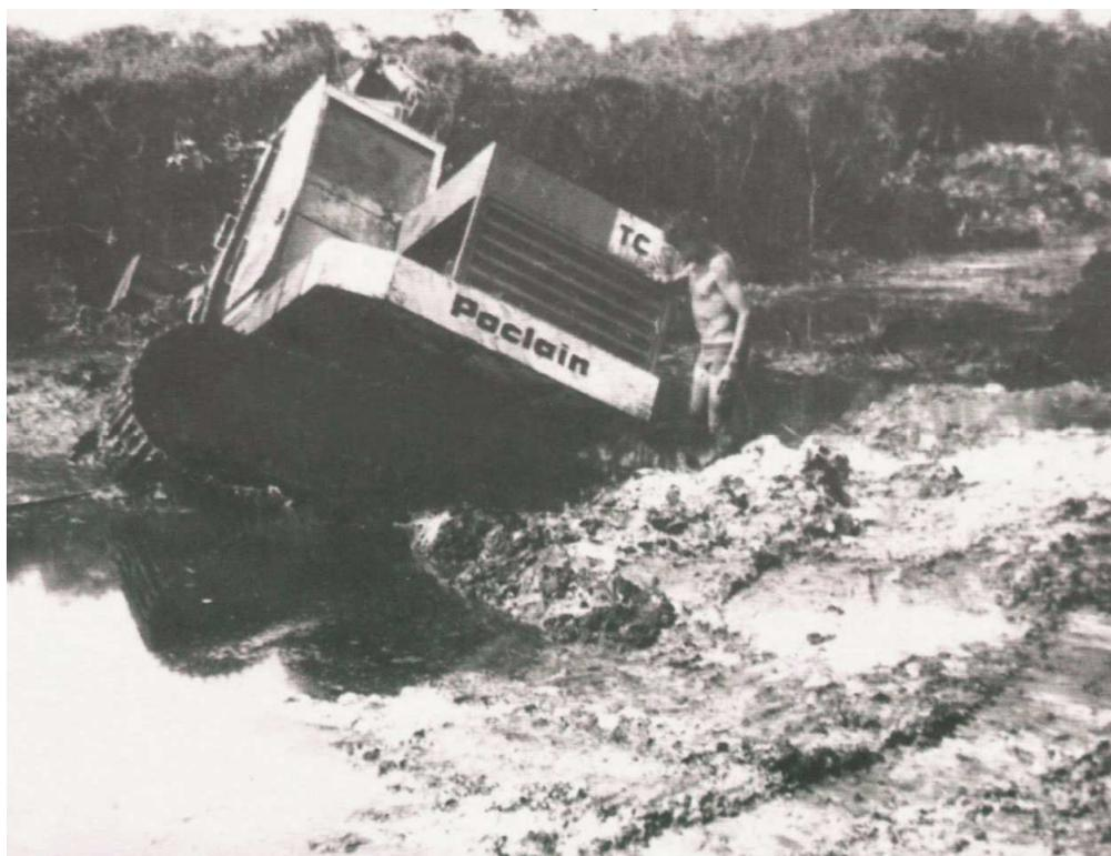
Figura 5 – Trator atolado no solo arenoso e encharcado
