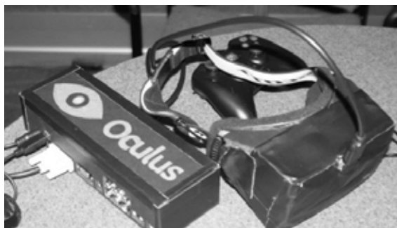
Fig. 68: um dos primeiros protótipos do Oculus Rift (2012) 129 .
