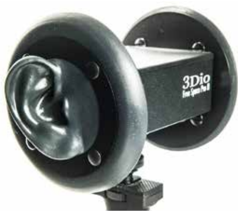
Fig. 33: microfone binaural em formato de orelha humana 74 .
