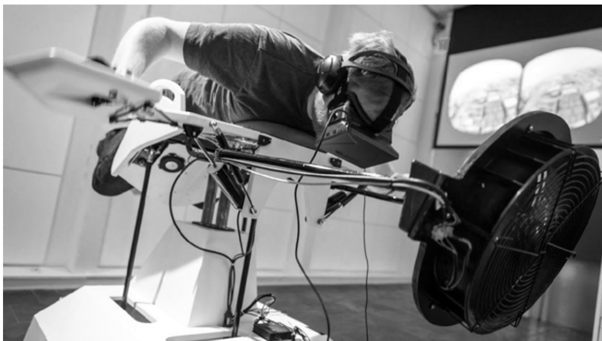
Fig. 77: sistema Birdly, um simulador de voo livre composto de uma prancha móvel e um ventilador de alta potência, para simular o vento durante a experiência (2014) 149 .
