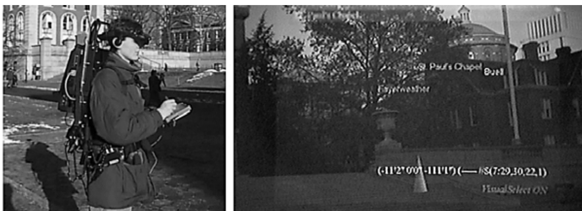
Fig. 57: o Feiner's Touring Machine (1997) era um sistema portátil montado em uma mochila de viagens e permitia obter informações sobre prédios históricos e pontos turísticos 110 .
