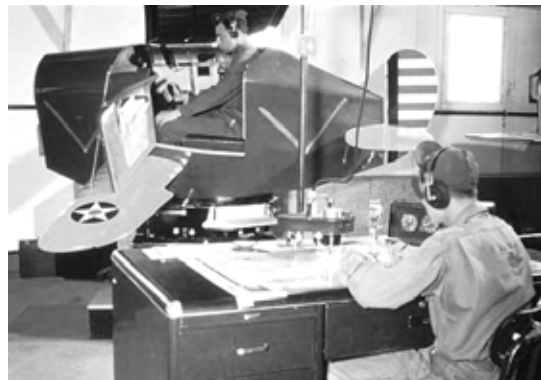
Fig. 18: o Link Trainer , ainda em sua configuração original (1929) 49 .
