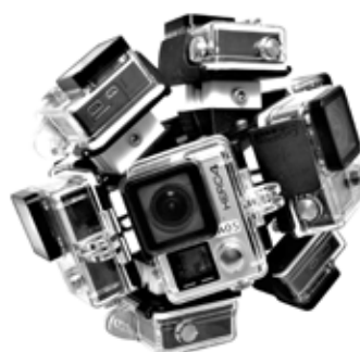
Fig. 49: rig com 10 câmeras GoPro 98 .
