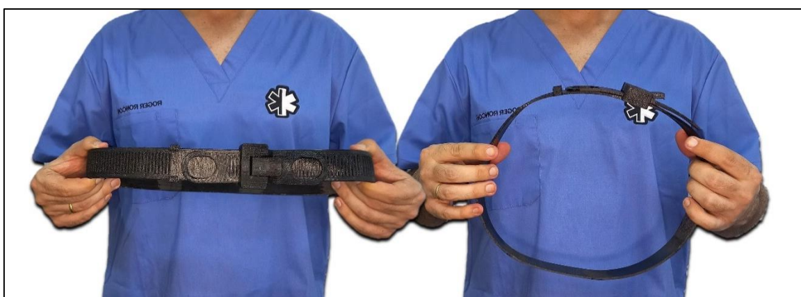
Figura 26 - Resultado do primeiro protótipo por impressão 3D com filamento de TPU flexível, produzido em partes e com processo artesanal de fundição. Imagem para ilustrar dimensão do dispositivo perto do corpo humano. Fonte: o Autor.
