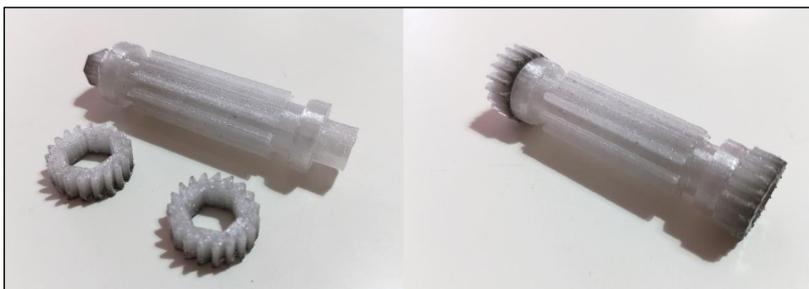
Figura 57 – As 3 peças novas, impressas em PETG XT.
