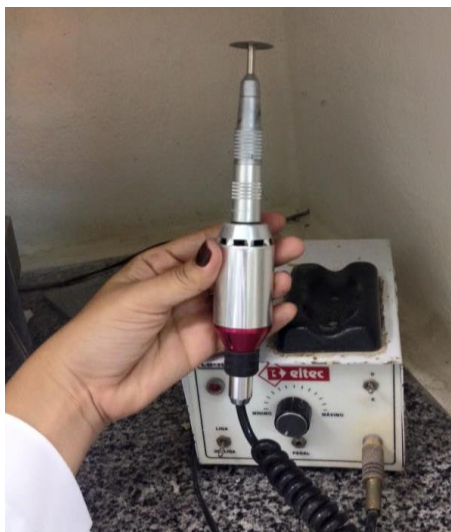
Figura 1 - Aparelho com motor de alta velocidade (modelo LB-100 R Beltec) com fórceps reto acoplados a discos de diamante (KG Sorensen - 7020 R) utilizados para corte dos dentes e obtenção das amostras.
