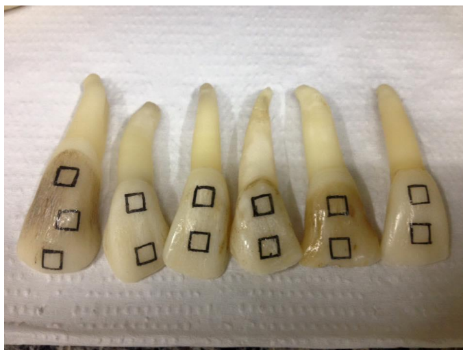
Figura 2 - Dentes bovinos com marcação de 4x4 mm em face vestibular preparados para corte.
