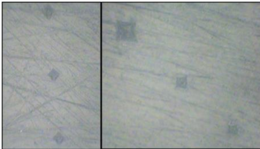
Figura 14 - Imagens microscópicas da superfície do dente, mostrando as endentações
