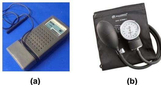
**Figura 8: Instrumentos para medição do ITB. (a) Doppler vascular e (b) Esfigmomanômetro analógico.**
