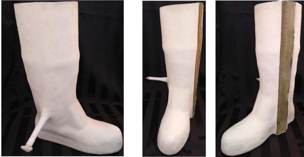
Figura 11 - Bota em fibra de vidro usada no presente trabalho para avaliação de volumetria de edemas. Fonte: Autor.
