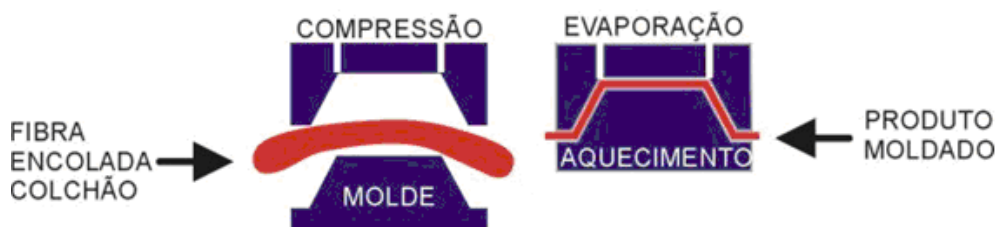
Figura 1 - esquema do processo de moldagem a quente
